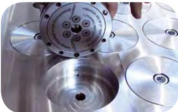
UNILOCK ASM 90 direkt eingebaut in den Maschinentisch. Leerstehende Befestigungsbohrungen wurden hier abgedeckt
