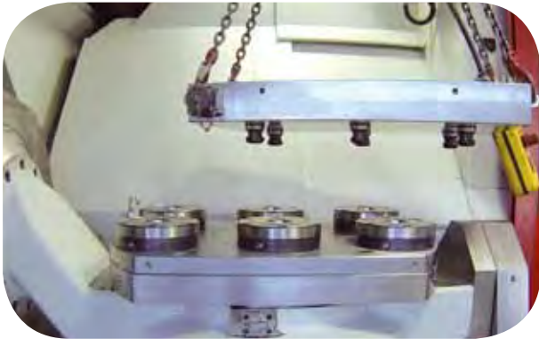
UNILOCK 6-fach Spannstation mit eingebauten ESM 138 für zeitsparendes Wechseln von Magnetplatten
