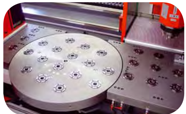
UNILOCK ESM 138 voll eingebaut in den fixen sowie in den rotierenden Maschinentisch
