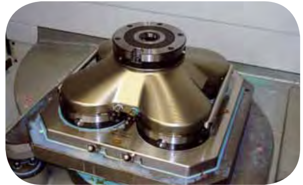
UNILOCK 4-fach Spannstation mit eingebauten ESM 138 zur Aufnahme einer UNILOCK Spannbrücke mit einem ESM 176-V
