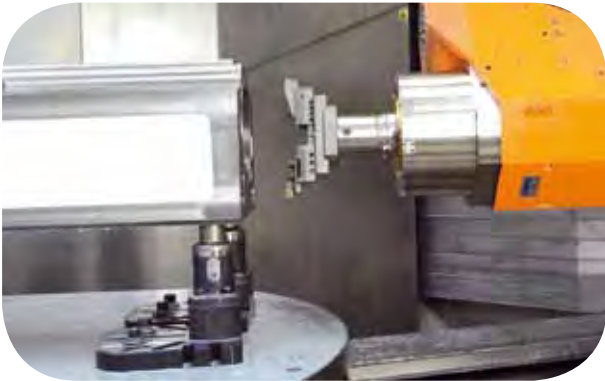
UNILOCK 5-Axis Anwendung direkt aufgebaut auf einem Lochraster Maschinentisch (Basissfuß H100 / Basismodul H100 / Reduktion H50)
