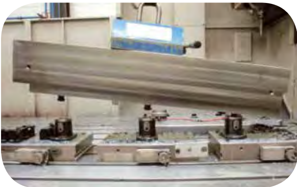
UNILOCK 5-Axis Anwendung, aufgebaut auf Magnetplatten (Basismodul H100)
