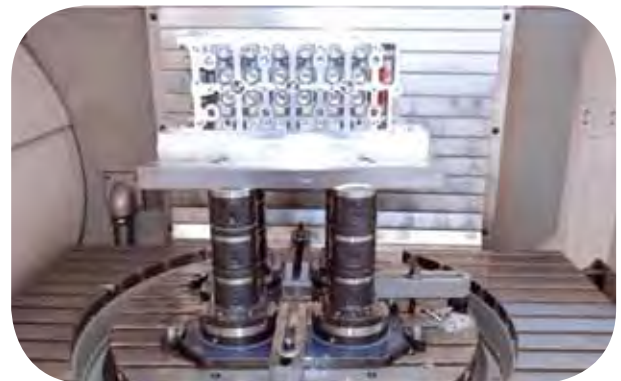
UNILOCK 5-Axis Aufbau auf einer UNILOCK 4-fach Spannstation (Basismodul H75 / Aufbaumodule H75)
