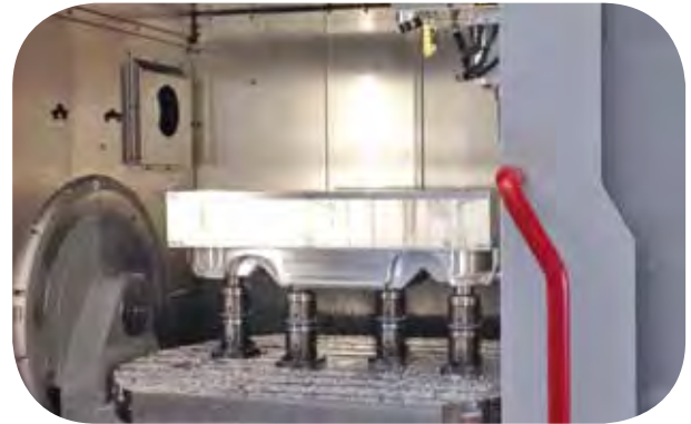
UNILOCK 5-Axis Aufbau direkt auf T-Nuten Maschinentisch (Basismodul H100 / Adapter H75 / Reduktion H50)
