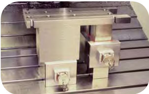
Magnetspannblock mit festen Polverlängerungen, direkt aufgebaut auf Maschinentisch (QX-Block HD70 H100,2 / PVQ 70 H45)
