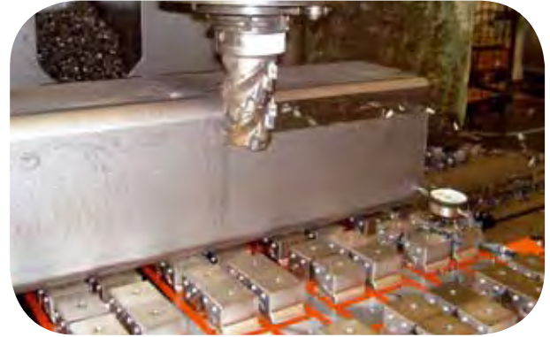
Magnetspannplatte mit mobilen Polverlängerungen für Fräsverfahren (QX-HD70 / H68 / MP 70 H45)
