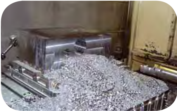
Magnetspannplatte mit festen + mobilen Polverlängerungen, aufgebaut auf Maschinentisch (QX-HE 50 H51 / PVQ 50 H32 / MP50 H32)
