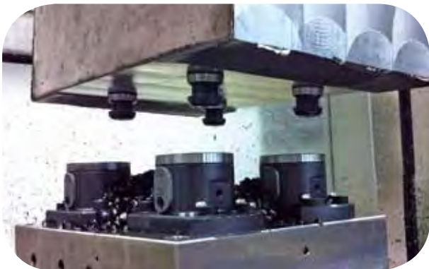
UNILOCK 5-Axis gespannt durch Spannbolzen mit Durchgangsbohrung + Pendelschraube (Basismodul H75 / SBA+SBC 40-25-5-DG16.5)
