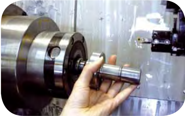
UNILOCK ESM 138 verwendet mit Standard Spannbolzen zum Drehen von Einzelteilen (ESM 138 / SBA 40-25-5-12)
