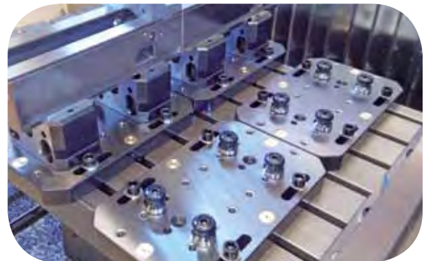
UNILOCK 5-Axis DUO Basismodule gespannt durch Spannbolzen mit Zentrierbohrung + Passschraube (DUO Basismodul H150 / SBA+SBC 40-16-0-0)
