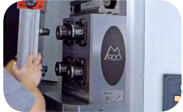
UNILOCK 5-Axis Vertikalaufbau gespannt mit Standard Spannbolzen (Basismodul H75 / SBA+SBB+SBC 40-25-5-12)
