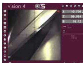
Fasensbreite mit Lotfunktion Chamfer width with perpendicular
