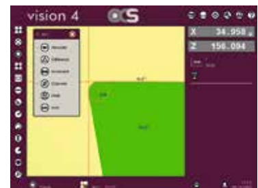
R/D und Absolut-/Kettenmaß Auswahlen Radius/ dia and abs/ inc selectable
