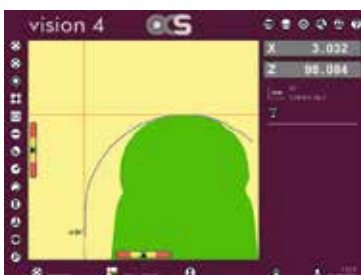
Summenbild, Wirkkonturerfassung an sich drehendem Werkzeug Detects and measures the contour on a rotating tool
