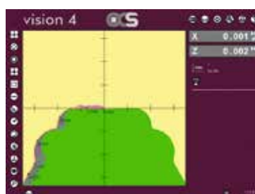
DXF-Overlay für SOLL-IST Vergleich (optional) DXF-files for nominal/ actual comparisons (optional)
